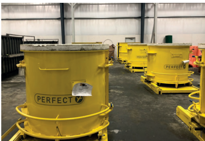
Литьевые формы Perfect для производства изделия по технологии твердения в опалубке просты в обслуживании: их переналадка, заполнение, распалубка и очистка не составляют никакого труда
